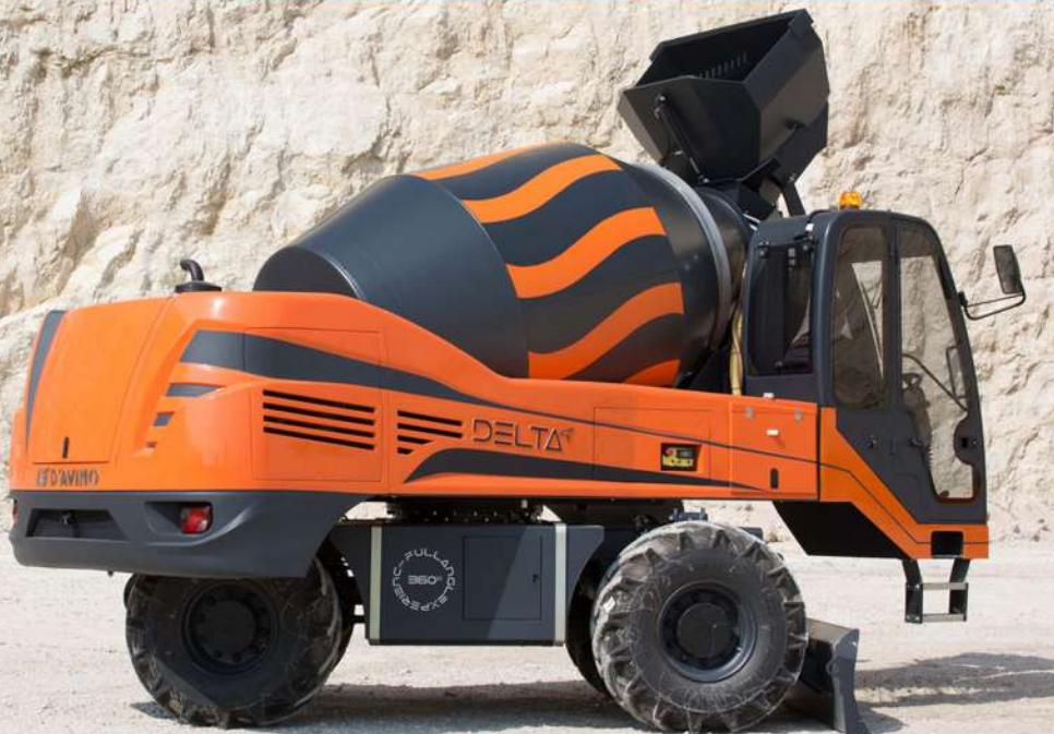
**DESCRIPCIÓN** (UNI 10929:2011) Autohormigonera autocargante - Horni-gón producido 4,5 m3 (tipo S1) - Dirección de carga/descarga giratoria a 360° de forma continua - N.4 ruedas motrices y direccionales - Carga mediante pala articulada - Cabina de conducción soldada al tambor y giratoria a 360° de forma continua
